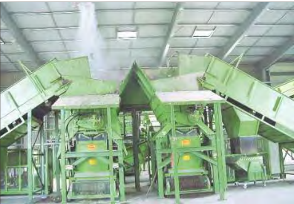
MBRA im Abfallbehandlungszentrum Wiewärthe Pößneck: Shredder zur Behandlung von Haus- und Sperrmüll
